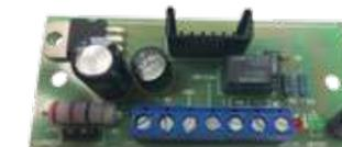
Permite la utilización de un receptor enchufable en instalaciones no dotadas de conector de radio – enlace por cable
