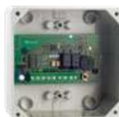
Receptor seguridad vía radio 868MHz
