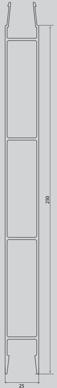
Con la misma calidad que en el modelo BARCELONA, aumentando el espesor de la perfilaría y la altura de las lamas en 50 mm, para tener una puerta más resistente con el mismo diseño.
