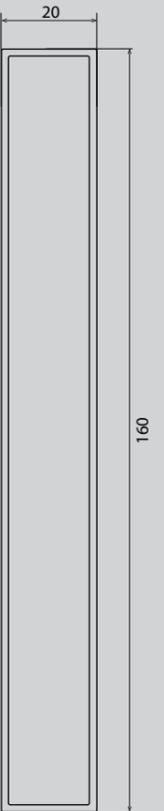
Material exclusivo de primera calidad, con la garantía antióxido que ofrece el aluminio. Juntas fijadas mediante soldadura, tirador y manivela interior de Inox. Lamas de 160 mm, con una separación entre ellas desde 25 mm.
