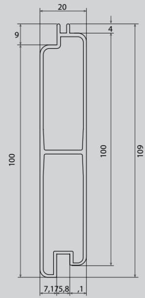
Material exclusivo de primera calidad, con la garantía antióxido que ofrece el aluminio. Juntas fijadas mediante soldadura, tirador y manivela interior de Inox, con una anchura de lamina de 100mm.
